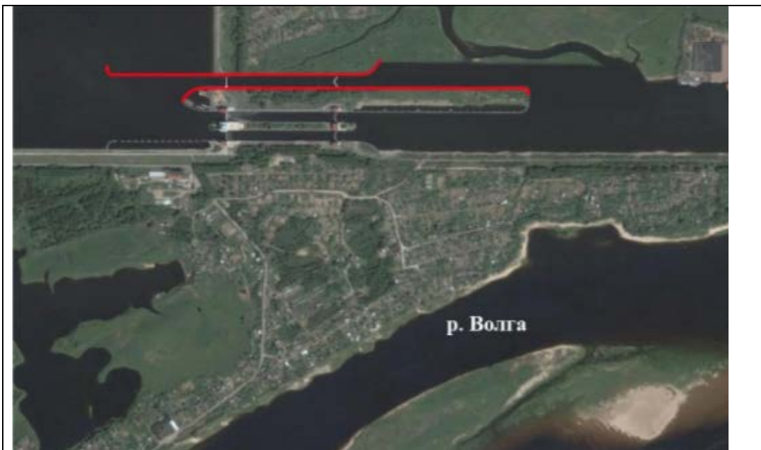
Рис. 6. Вариант строительства третьей нитки судоходного шлюза.
