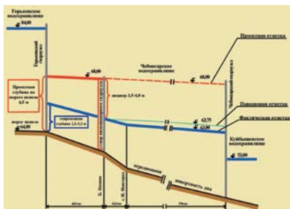
Рис. 4. Схема строительства низконапорного гидроузла, совмещенного с автодорогой
